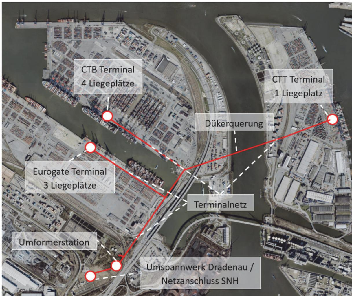
Abbildung 3: Übersichtskarte Landstromversorgung Containerschiffe mittels Anschluss an das öffentliche Stromnetz (Grobkonzept)
