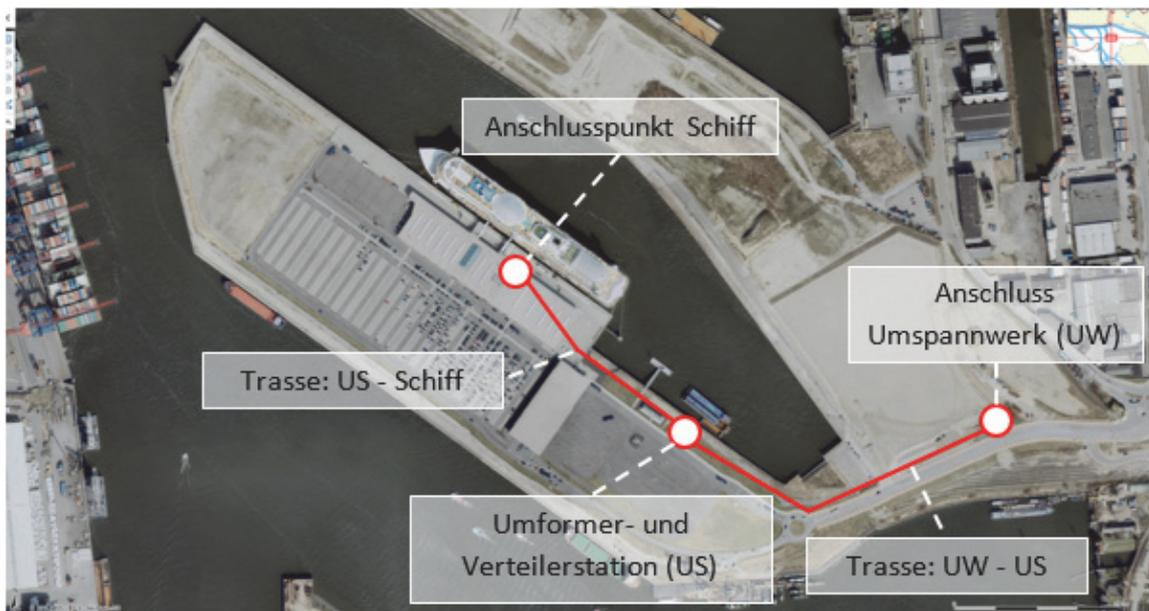
Abbildung 5: Übersichtskarte Landstromversorgung Kreuzfahrtschiffe am Terminal CC3 (Grobkonzept)
